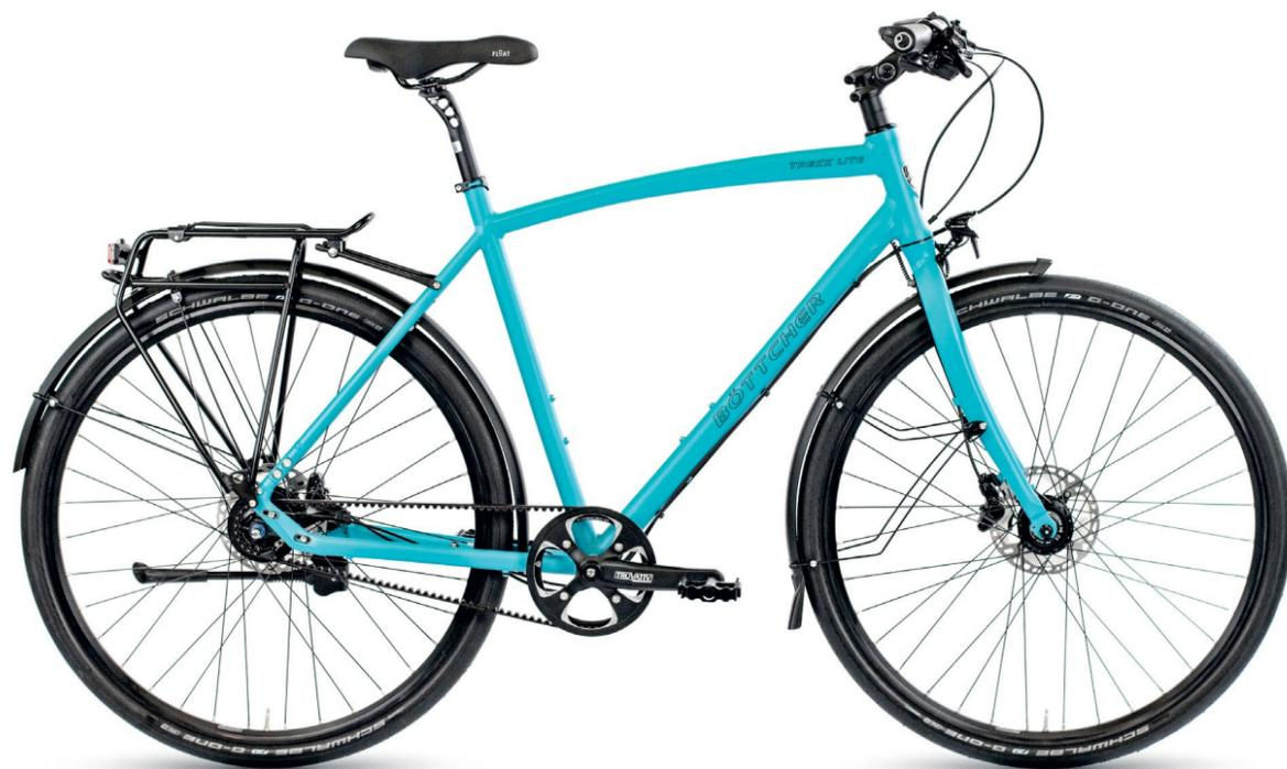
**RAHMENMATERIAL** — Alu triple butted flat welded **RAHMENFORM** — Diamant **GRÖßE** — 52, 57, 61 cm **LAUFRADGRÖßE** — 28“ **GEWICHT** — ab 13,2 kg **BESONDERHEITEN** — Schwalbe G-One Speed 40-622 Reifen, hydraulische Shimano Disc Bremsen, Ergon GP1 L Griffe, Selle Royal Classic Float Sattel, busch+müller Eyc T senso plus, Racktime Lightit Touren Gepäckträger, gatesfähiger Rahmen für Riemenantrieb, über 250 Farben zur Auswahl (siehe Seite 11), individuell konfigurierbar
